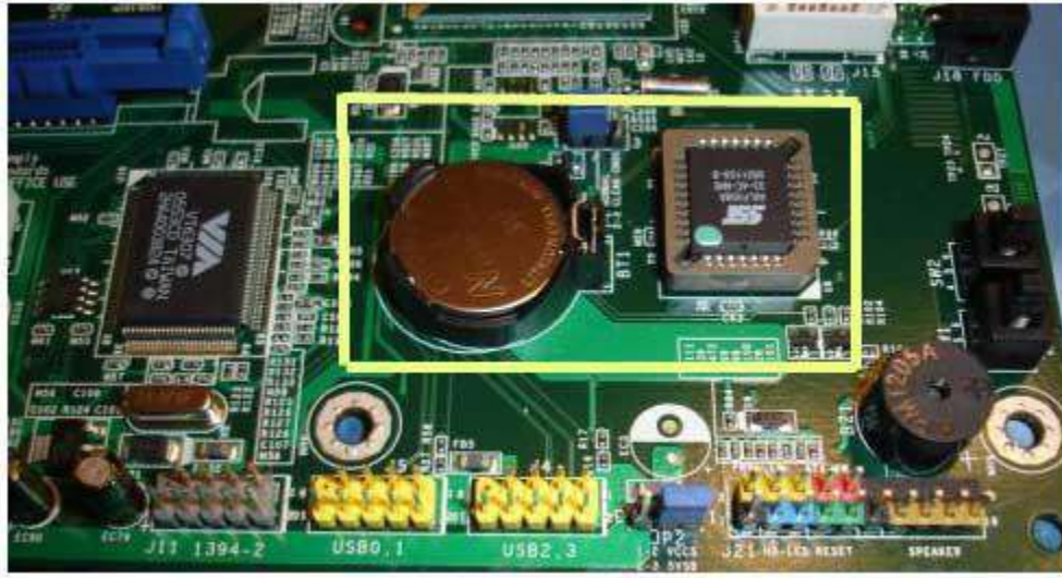
Şekil 62 Anakart üzerindeki Bios pli ve denetçisi
