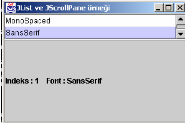
Şekil 7.27 JListTestiSWF.java programı sonuçların JFrame penceresinde görünümü
