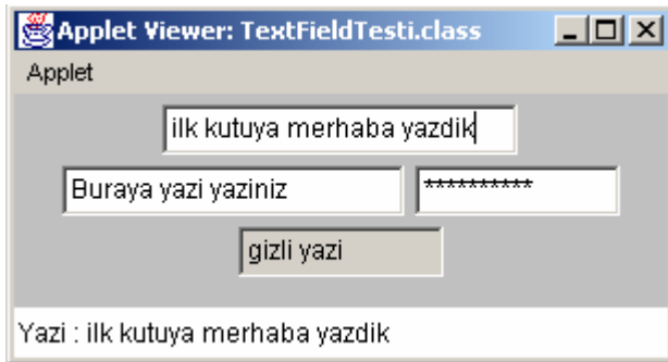
Şekil 7.10 TextFieldTesti.java programı sonuçlarının appletde görünümü
