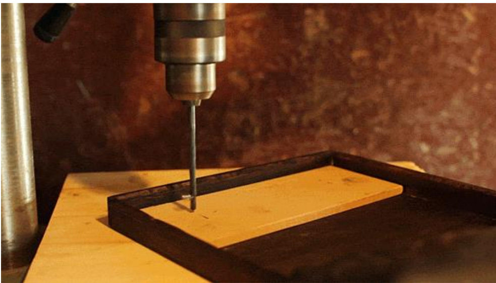
Şekil 1.4. Delik delme temel çalışma prensibi (kaynak: https://www.instructables.com/id/Custom-Antique-Steel-Lock-and-Wood-Box/ )
