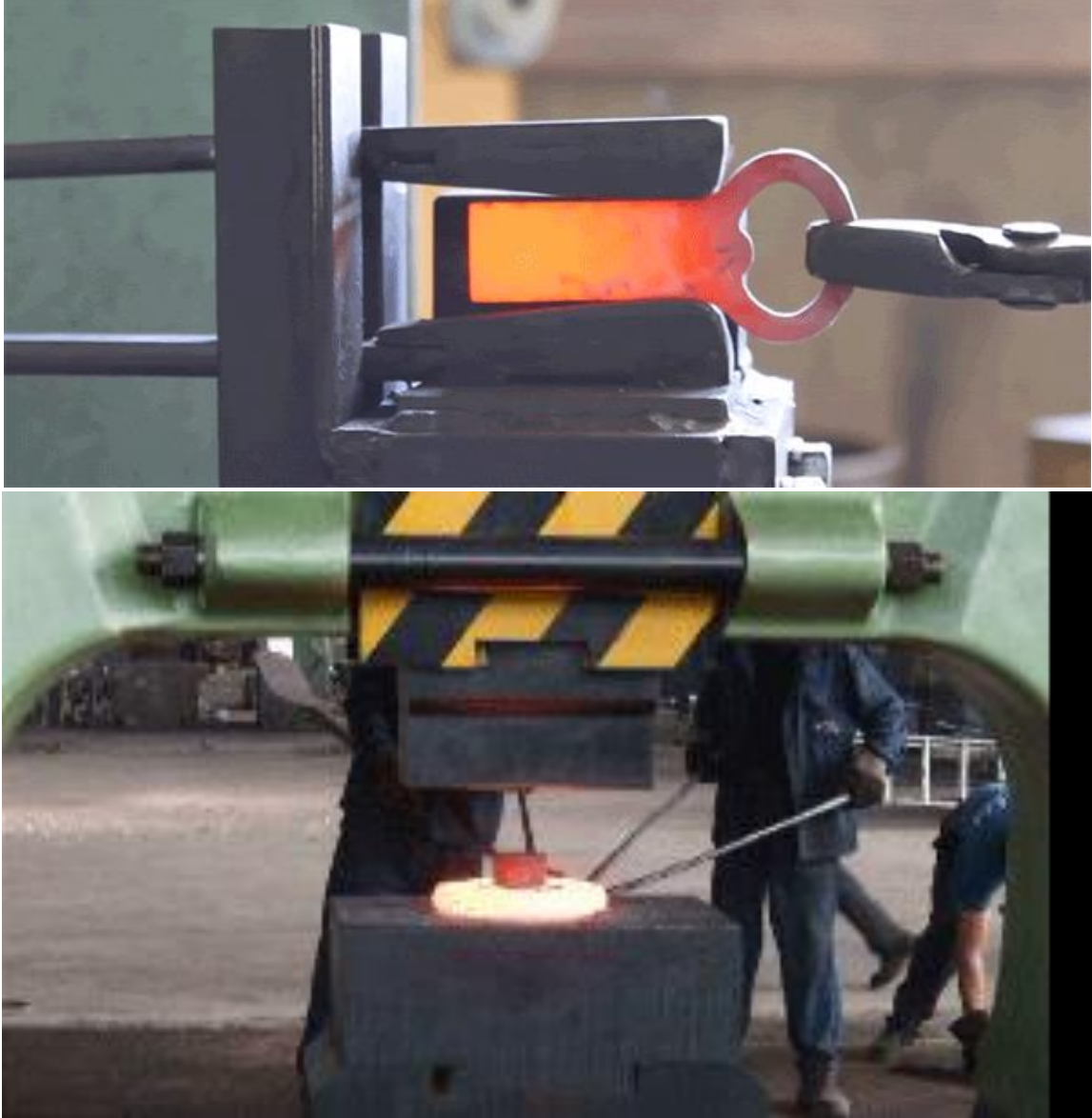
Şekil 1.11. Dövmeye işlemi temel çalışma prensibi (kaynak: üst: https://gifer.com/en/BIXV , Alt: https://imgur.com/gallery/BaMaB )
