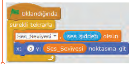
Resim 6.65: Ses seviyesine göre ekrandaki kuklayı zıplatan uygulama
