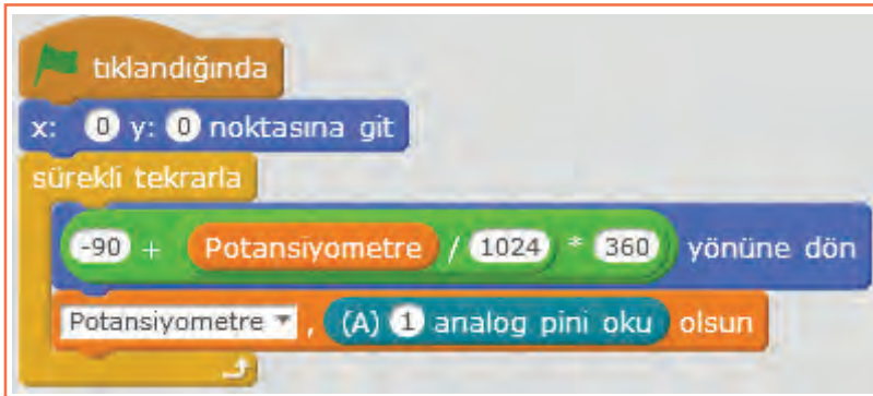
Resim 6.49: Arduino UNO ile Potansiyometre uygulaması örneği
