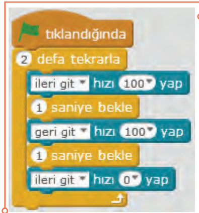
Resim 6.54: Robot hareketi için DC motor kullanımı örneği
