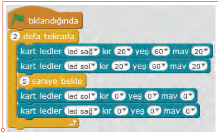
Resim 6.56: mBot Robot üzerindeki RGB LED kullanım örneği
