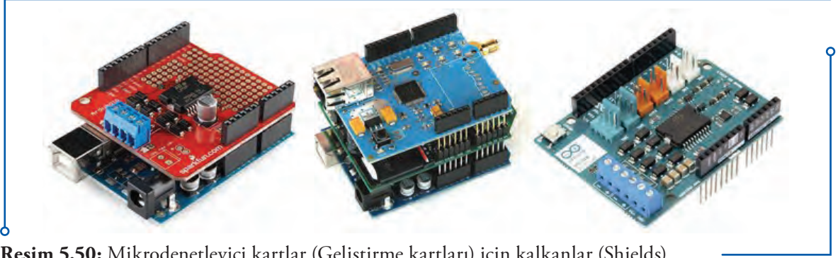
Resim 5.50: Mikrodenetleyici kartlar (Geliştirme kartları) için kalkanlar (Shields)
