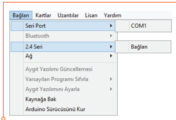
Resim 6.13: mBlock ile robot arasındaki bağlantının oluşturulması
