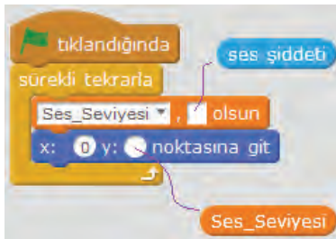
Resim 6.66: Ses seviyesine göre ekrandaki kuklayı zıplatan uygulama
