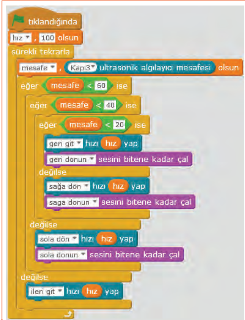
Resim 6.61: Ultrasonik algılayıcı kullanarak engele çarpmadan dolaşma uygulaması
