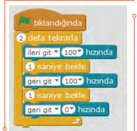
Resim 6.31: Verdiğimiz sayı kadar işlemi tekrarlayan döngü örneği
