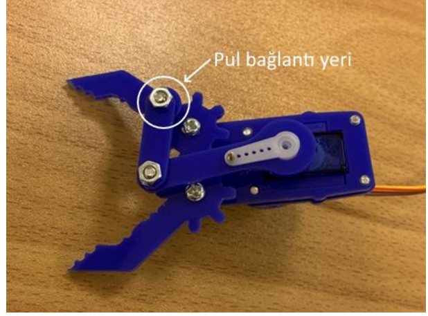
Bağlantı sonrası alttan görünüm.
