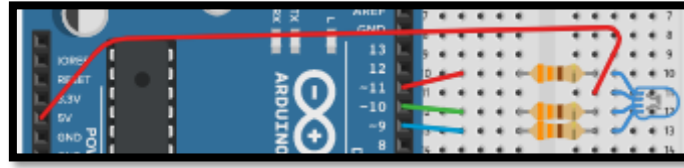
Resim 109. Ortak Anot RGB Örnek Devre Şeması
